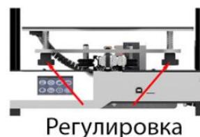
После выравнивания вы можете перемещать печатающую головку от одной точки к другой, чтобы проверить расстояния между соплом и платформой.
