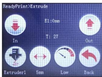
Если вы хотите заменить нить или вынуть нить из принтера, нажмите «Extrude», чтобы войти в меню подачи и втягивания, нажмите «Out», пока нить не выйдет из головки принтера.
